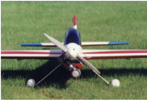
Le Nova équipé du ST90 et l'hélice APC 14x6
