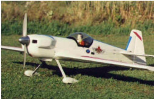
Le Cap 232 équipé du ST2300 et de l'hélice APC 17x8
